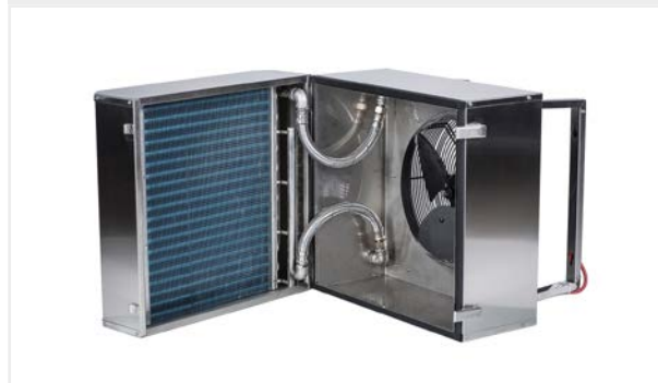
Передняя панель аппаратов SWX CS и SWX D легко открывается для регламентной чистки. У моделей серии SWX EX предусмотрен быстросъемный инспекционный люк.
